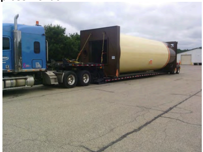
Photo 2 : Silo / camion-remorque de 27,70 m de long et 3,65 m de largeur (52 000 lb)
