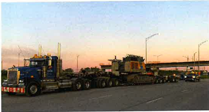
Transport d'une chargeuse sur chenilles par un camion-semi-remorque 11-essieux
