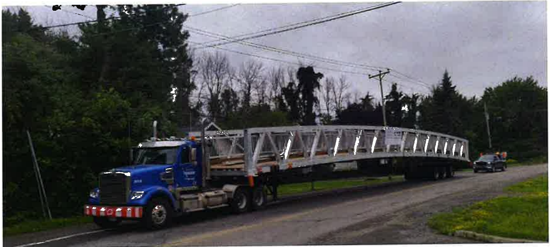
Transport surdimensionné avec escorte routière d'une passerelle fabriquée au Québec
