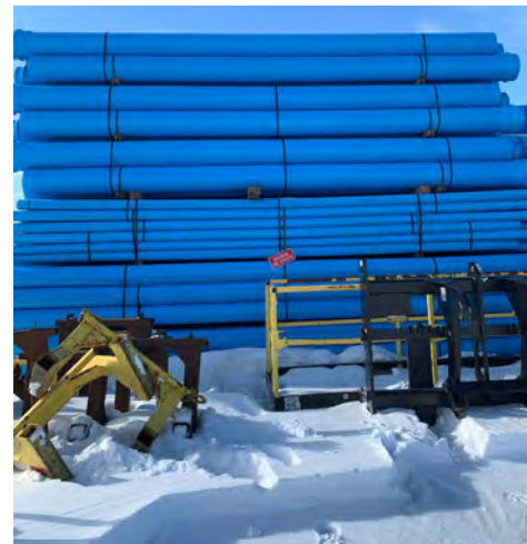
Véhicules trop prêts de l'entreposage, entreposage plus de 10' de haut
