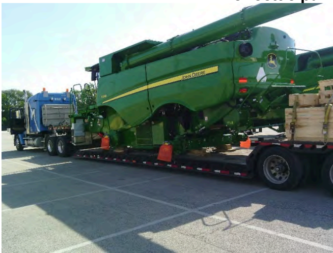
Photo 1 : Batteuse / 3,65 m de largeur (55 000 lb)
