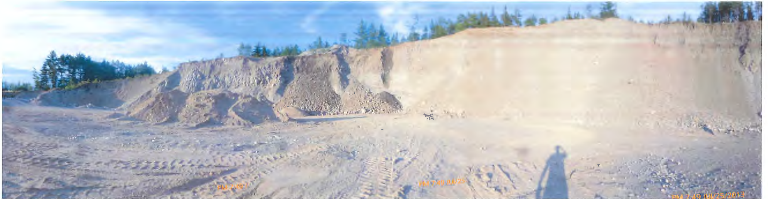
Sud du rang 3. Front d'exploitation est. Aucune trace de conservation du sol arable.
