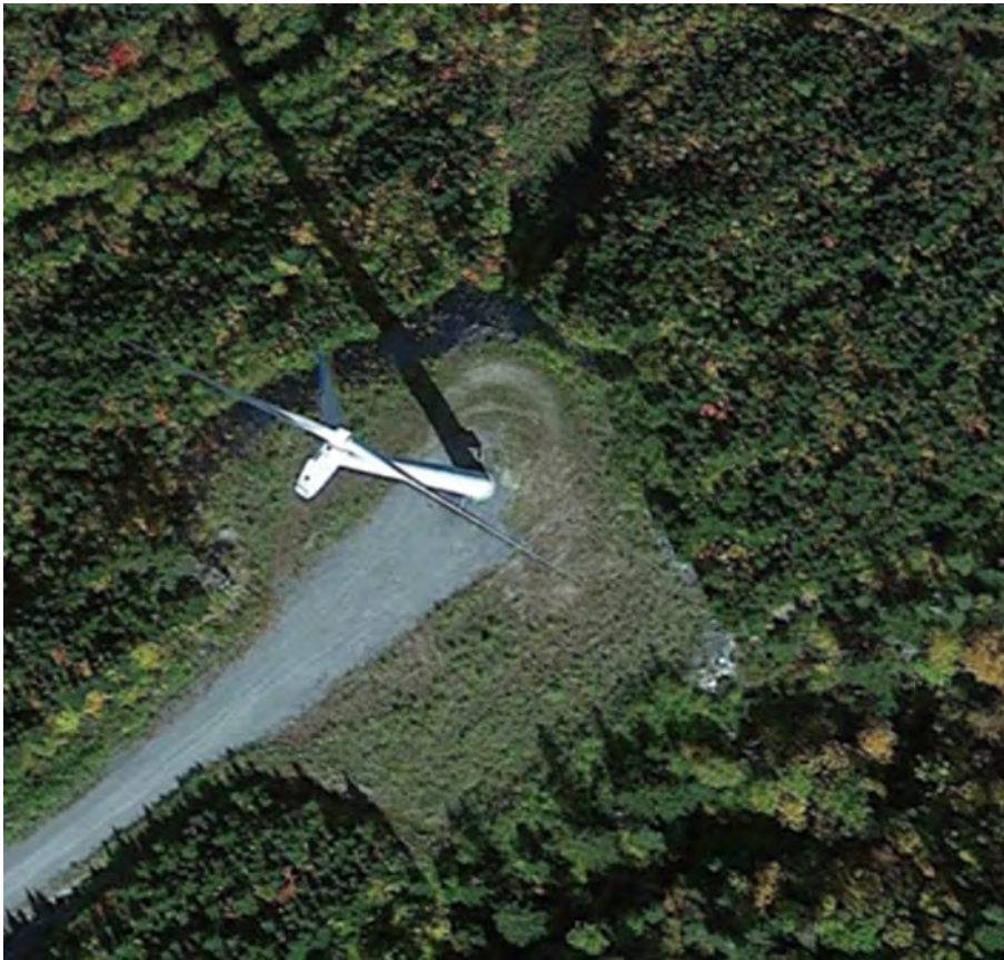
Figure 1 Reprise de végétation dans environ 50 % de l'aire totale nécessaire à la construction d'une éolienne en milieu boisé
