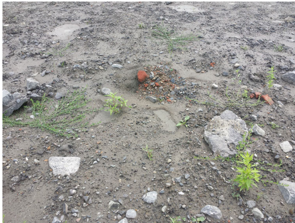
Photo 4 : Morceaux de briques dans le remblai.
