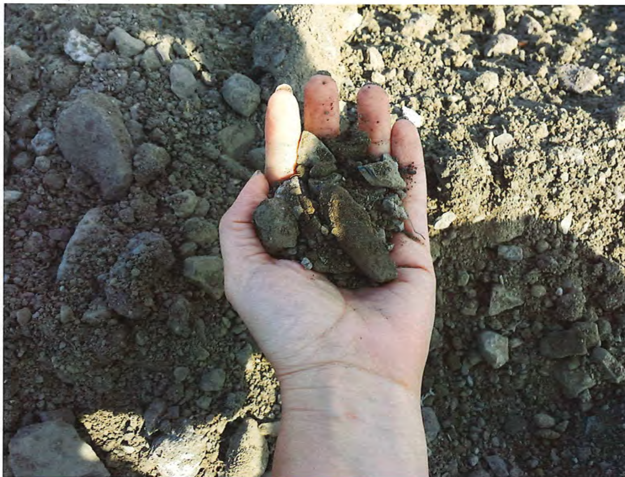
Photo 5 : Type de sol constituant le remblai
