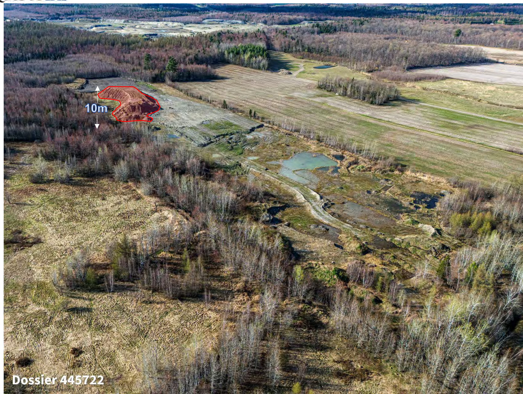
Photo 4 : Vue aérienne du lot 2 639 356. L'amas de matériel en rouge a été mesuré à 10m de hauteur à l'aide de l'altimètre du drone.
