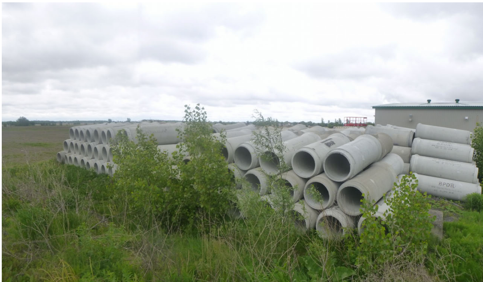
Photo 8 : Ponceaux à côté du garage mécanique.
