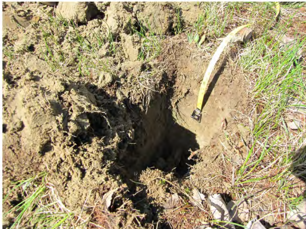
Terrain naturel le long du boisé : 10 cm de sol arable de texture sableuse, surplombant un sol sableux sans pierre ni gravier
